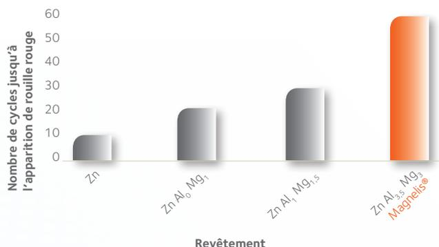
Revêtement de 10 µm soumis à un cycle alterné de 8 heures : cycle de brouillard (5 % de NaCl) / cycle sec / cycle d'humidité
