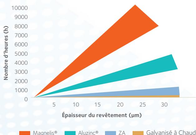
Résistance à la corrosion par un essai au brouillard salin (moyenne)
