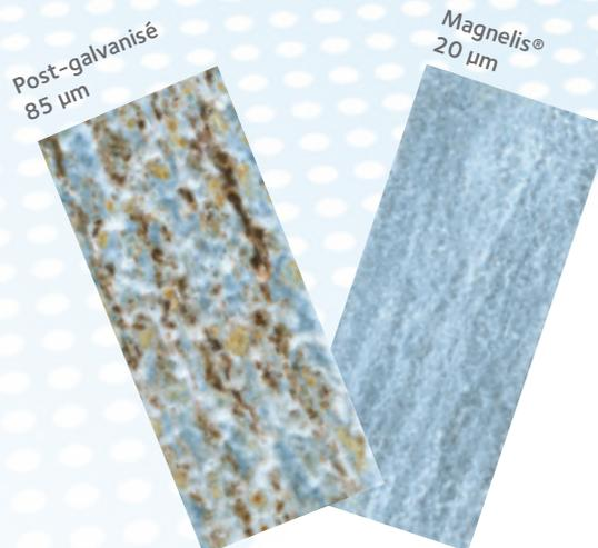
Test au brouillard salin pendant 2 000 heures
