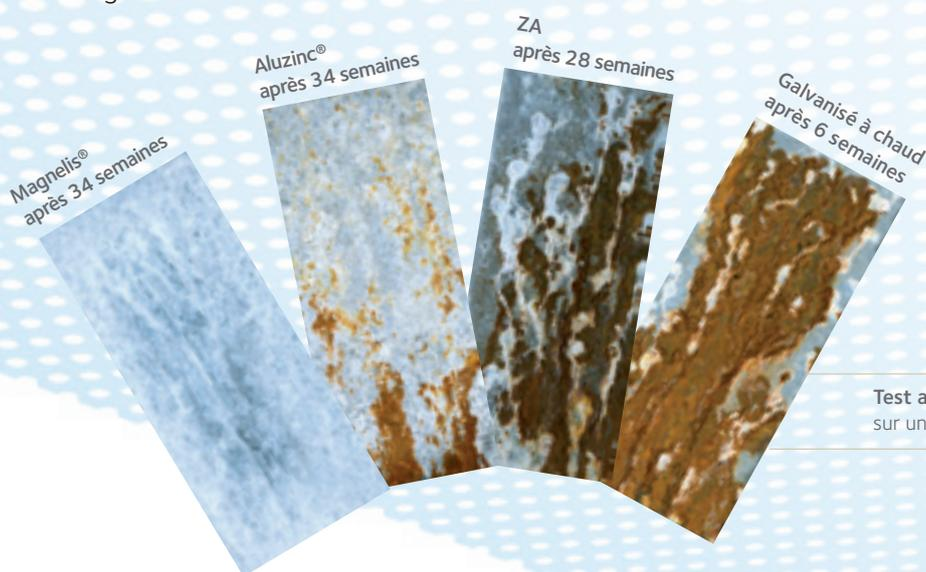
Dans des environnements hautement alcalins (pH compris entre 10 et 13), Magnelis® présente une résistance à la corrosion supérieure à d'autres revêtements métalliques.
